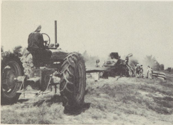
جرارة تمد القوة لجهاز يدرس الغلة ميكانيكيا في الخرج
