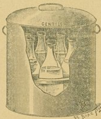
شكل ٦٠ - جهاز سو كسهليت بأبسط أشكاله لغلي اللبن
