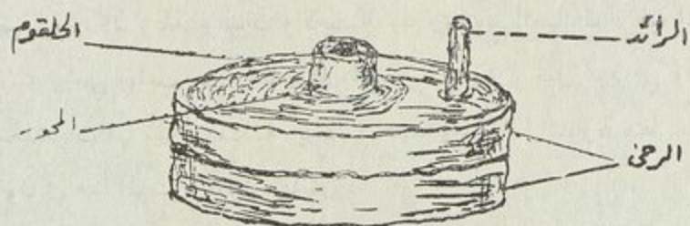
شكل ( ٥ ) الجاروشة المؤلفة من قرصين من الحجر الاسود
