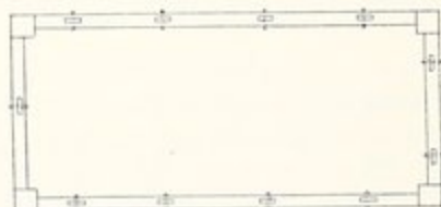
Fig. 12. — Cuve. Tenons du couvercle maintenus par des chevilles (41018).
