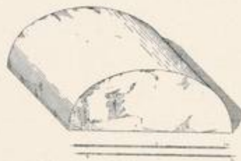
Abb. 18. Schlussprofil der Umfassungsmauer.
