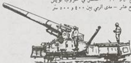
مدفع أوتوماتيكي حيار ٨١ ميليمترًا - اختراع سنة ١٩٥٣ - المدى الأقصى للرمي : ٣٢ كم
