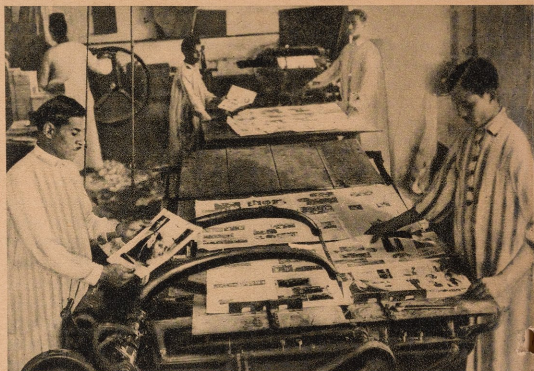
صورة أخرى أخذت في قسم التجليد ، وهي تمثل الآلة الاوتوماتيكية التي تقوم بطي المجلات لاعدادها للتوزيع على باعة الصحف
