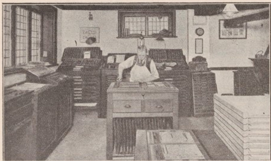
( شكل ٢٢٤ ) (١) صندوق الحروف (٢) خزان الاعداد ( تحت التوضيب ) وفي جوف الخزان أدراج الأطواق ( شاسيه )
