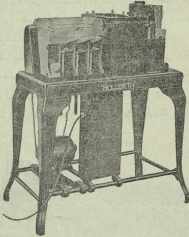
الشكل ٧ . الماكينة السريعة للتخريم بالجملة
